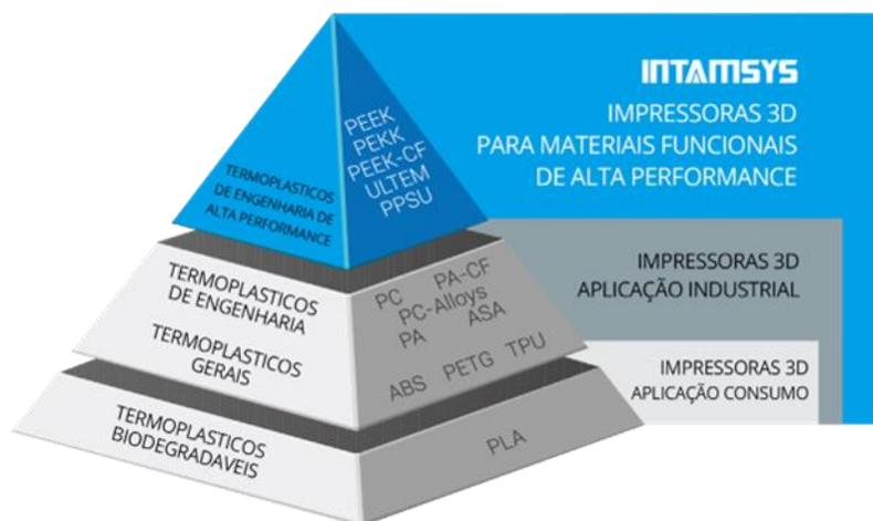
As impressoras 3D desktop convencionais atingem temperaturas de extrusão que variam entre 240° C e 270° C. Algumas poucas, atingem 300° C. Esse é um dos pilares no trabalho com termoplásticos funcionais: com máquinas que atingem entre 450° C e 500° C, a Intamsys® abre o leque de materiais, possibilitando inúmeras aplicações da impressão 3D à indústria.
